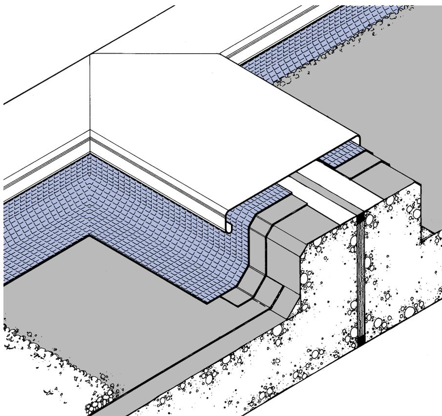
caucho/betún que facilita la óptima adhesión al soporte previamente imprimado y a todas las membranas de Grace.
